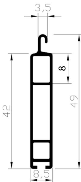
Note : Si la largeur du volet roulant est inférieure à 1000 mm, on livre dans le profil inférieur le poids métallique zingué 18x2 mm.
