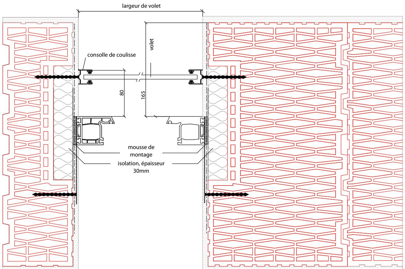
Utilisez la vis Fisher FFS ou FFSZ pour les cadres de fenêtre ou les chevilles appropriées de 80mm au min.
