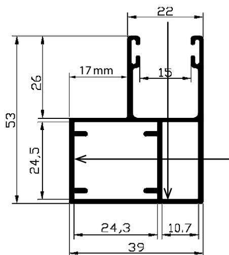
Note : Permet de garder la distance de 17 mm par rapport à la fenêtre sans créer une lacune entre la fenêtre et le côté derrière du box du volet roulant
