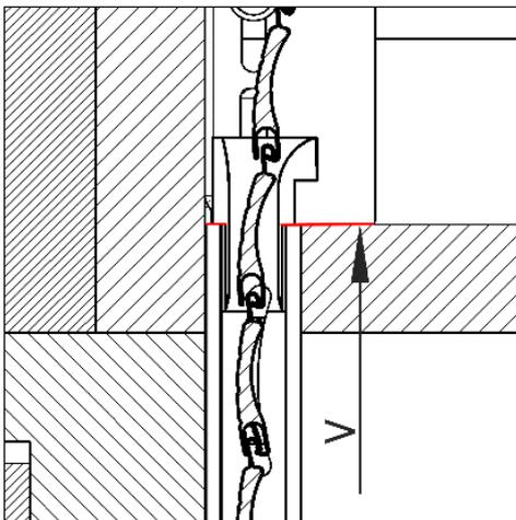
Le bord supérieur de la coulisse est rattaché à la cloison intérieure du côté inférieur d'un box.
