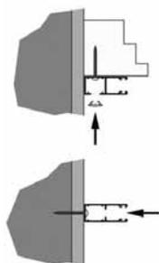
Perçage en gradins pour l'utilisation de embouts de couverture en PVC montage sur le châssis de la fenêtre
