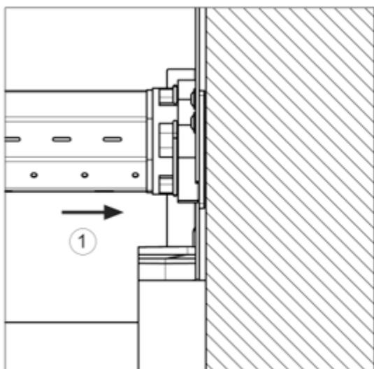
5.1) Installer le moteur au niveau de l'entraîneur, faire passer le câble du moteur vers l'armoire de distribution
